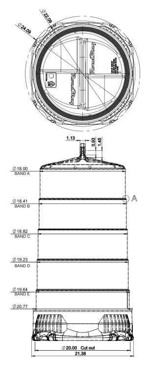
MATERIAL:IMPACT-RESISTANT POLYETHYLENE COLOR:UV-STABILIZED HIGHWAY ORANGE BODY HEIGHT: 36" (0.92 M)
